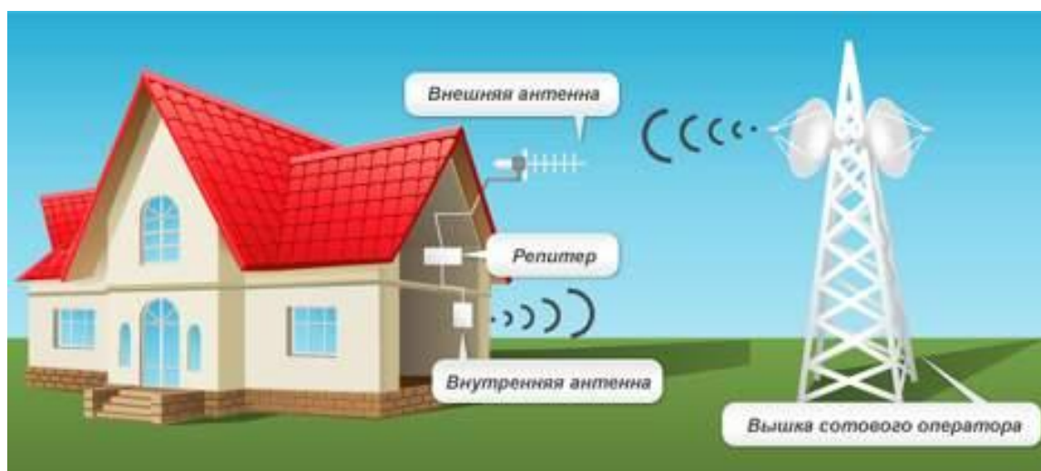
Рисунок 1 - Схема усиления GSM сигнала на примере частного дома
